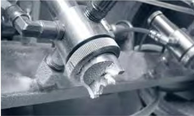
Die Luftkappe einer Zweistoffdüse mit Hörnern zeigt den typischen Produktaufbau (Bearding). Dieser verstopft die Luftkanäle und beeinträchtigt das Sprühbild. Die SCHLICK ABC Cap dagegen weist keinen Produktaufbau an der Düsenmündung auf und ermöglicht so weiterhin ein optimales Sprühbild.
